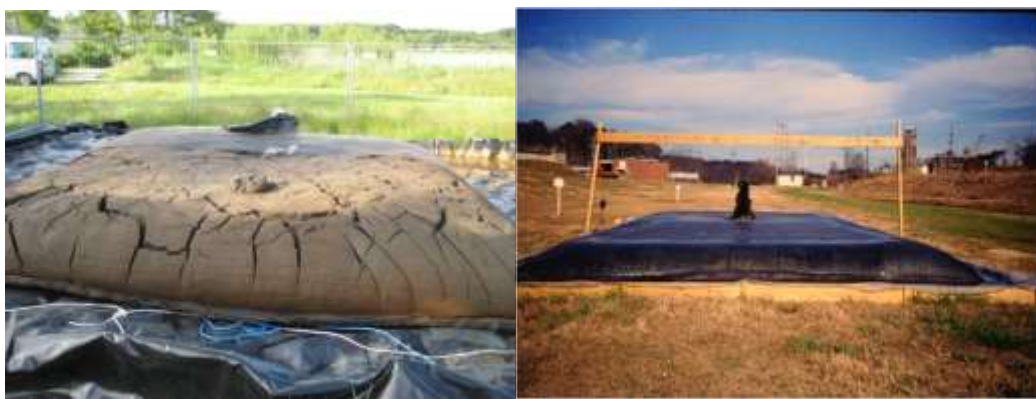
图 2.2-6 固结过程及固结后淤泥形态
